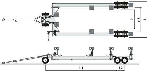
Les chariots CHS disposent de châssis renforcés et de systèmes de roues multiples afin de faire face aux diverses répartitions de charges suivant les coques manutentionnées. Nos chariots CHS sont réalisés selon votre cahier des charges dimensionnel (dans la limite des contraintes techniques) permettant la manutention de coques de 5 à 12 m tout en restant compact et facilement manoeuvrables sur le chantier. Timon avant de 3m à 5m.
