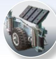
La nouvelle gamme de chariots hydraulique de manutention CHS reprend le concept de levage par chandelles hydraulique réglables qui a fait le succès des BHS. Chaque chandelle, équipée d'un vérin hydraulique, est réglable individuellement en hauteur. Elle est équipée d'un large patin rotulé en élastomère 85 shore afin de protéger la coque et offrir une surface de portance optimum pour éviter tout problème de poinçonnage.
