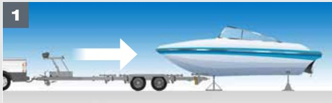
1 El remolque, abierto en la parte trasera, retrocede debajo del barco colocado sobre 2 soportes especiales con 3 puntos de apoyo. El conductor posiciona los soportes en el centro del remolque.
